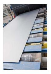
NLMK Clabecq produce planchas de acero al carbono de alta resistencia laminados en caliente. La fábrica suministra planchas reconocidas a nivel mundial por su acabado de superficie, su excelente planicidad y sus precisas tolerancias de espesor. Este resultado procede de nuestra larga experiencia combinada con equipos y tecnología de producción únicos: una laminadora Quarto y un tren de acabado continúo en cuatro fases en la misma línea de producción en secuencia.
